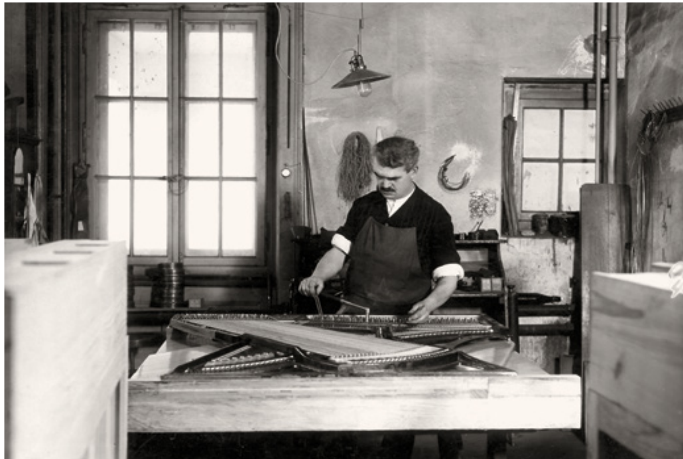
Ein Angestellter der Pianofabrik H. Wohlfahrt bezieht um 1930 die Saiten eines Klaviers.
